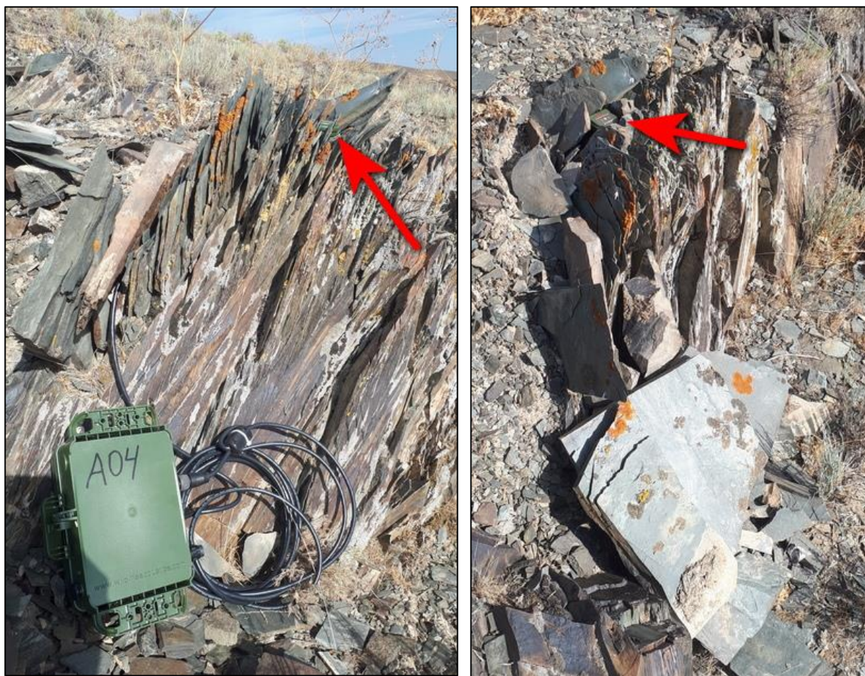
Рис. 52. Вариант скрытого размещения микрофона (отмечен красной стрелкой) стационарного детектора в камнях на горных склонах (слева — до маскировки детектора камнями, справа — после маскировки).
