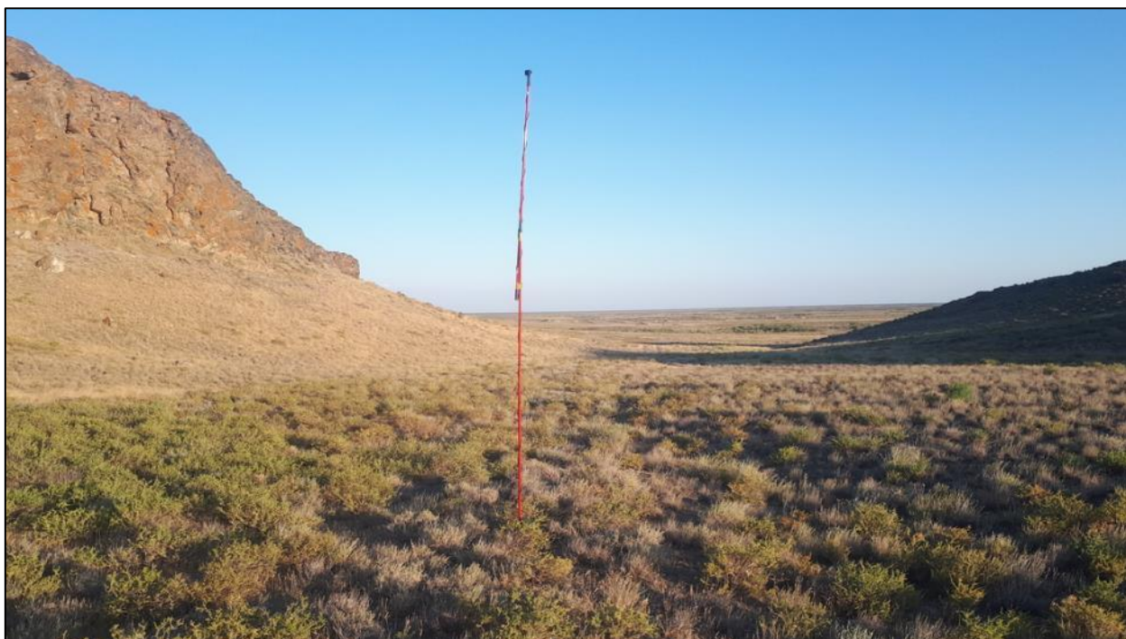
Рис. 51. Варианты размещения микрофонов стационарных детекторов за пределами горных склонов (вверху — микрофон детектора закреплен на верхушке небольшого дерева; внизу — микрофон поднят на телескопических стойках высотой 2–5 м).
